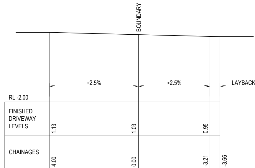
LONGITUDINAL SECTION MRV SERVICE RAMP 1:100 (NATURAL SCALE)
